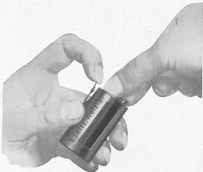
Figure 7. Comment on démonte le chargeur B.
