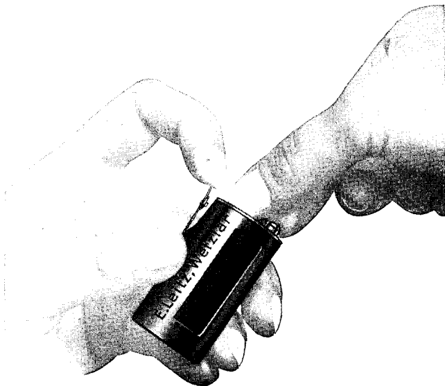
Figure 12. Comment on démonte le chargeur B.
