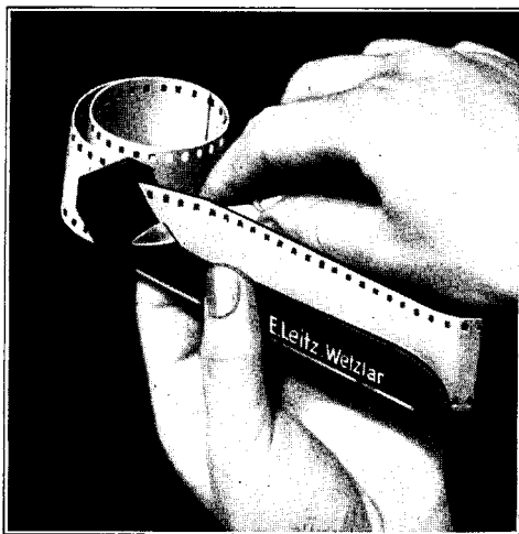
Figure 26. Calibre à biseauter. Coupe de l'extrémité du film pour la bobine réceptrice.
